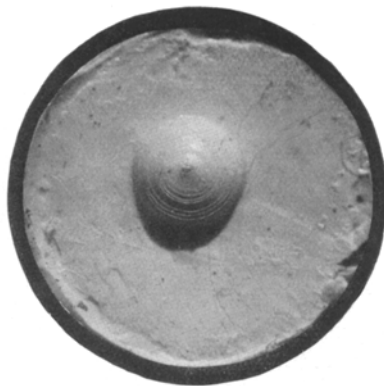
Abb. 4. Bleikörper mit Schlagbolzeneindruck.
